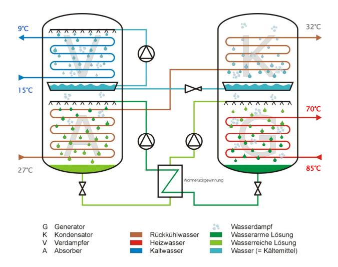
Die angegebenen Temperaturen der einzelnen Kreisläufe sind für den Standard-Betriebspunkt angegeben. Diese Temperaturen können in den technischen Grenzen der Anlage an die jeweils benötigten Projektbedingungen angepasst werden. Mehr dazu finden Sie unter Abschnitt 1.3 auf Seite 5 dieser Beschreibung.
